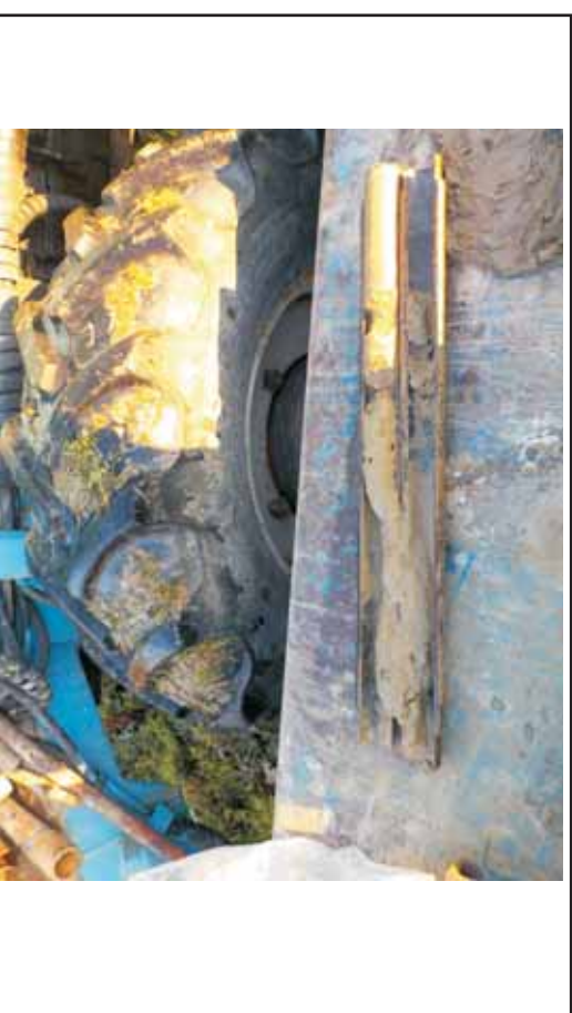
Campionatore Raymond: prova S.P.T. Da 1.80 a 2.25 m
